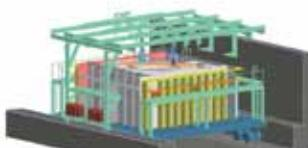
Перспективная технология изготовления баков МВЗ с использованием сварочных автоматов и роботов
