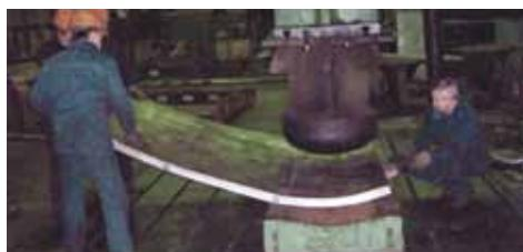
**В 2013–2014 гг. для ООО «Балтийский завод – Судостроение» была разработана принципиальная технология формирования бака металловодной защиты (МВЗ) ледокола проекта 22220.** Разработанная технология определяет общую последовательность выполнения работ по формированию бака МВЗ, а также включает мероприятия по снижению и компенсации сварочных деформаций, разработанные на основе результатов расчетной оценки ожидаемых деформаций, выполненной с применением метода конечных элементов.
